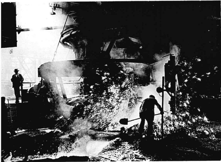
Coulée de fonte au haut-fourneau. Ed. de Wendel & Cie S.A. HAYANGE
